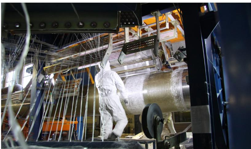
Благодаря используемым в НТТ технологиям производства на выходе мы получаем инертную, монолитную, прочную структуру стенки, состоящую из нескольких слоев с высокими гидравлическими характеристиками. В свою очередь, лайнерный слой (внутренняя стенка) обеспечивает требуемую стойкость к влиянию агрессивных и абразивных сред.
